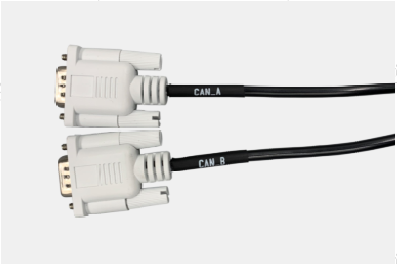
图 CAN转接线实物图
